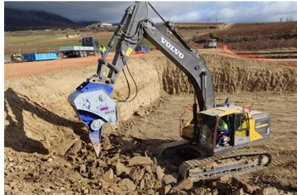
Fig. 7. Foto de *ripper* excéntrico tomada de internet.
