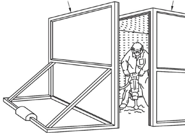
Figura 13. Ejemplo de apantallamiento móvil para trabajos con herramientas de mano.
