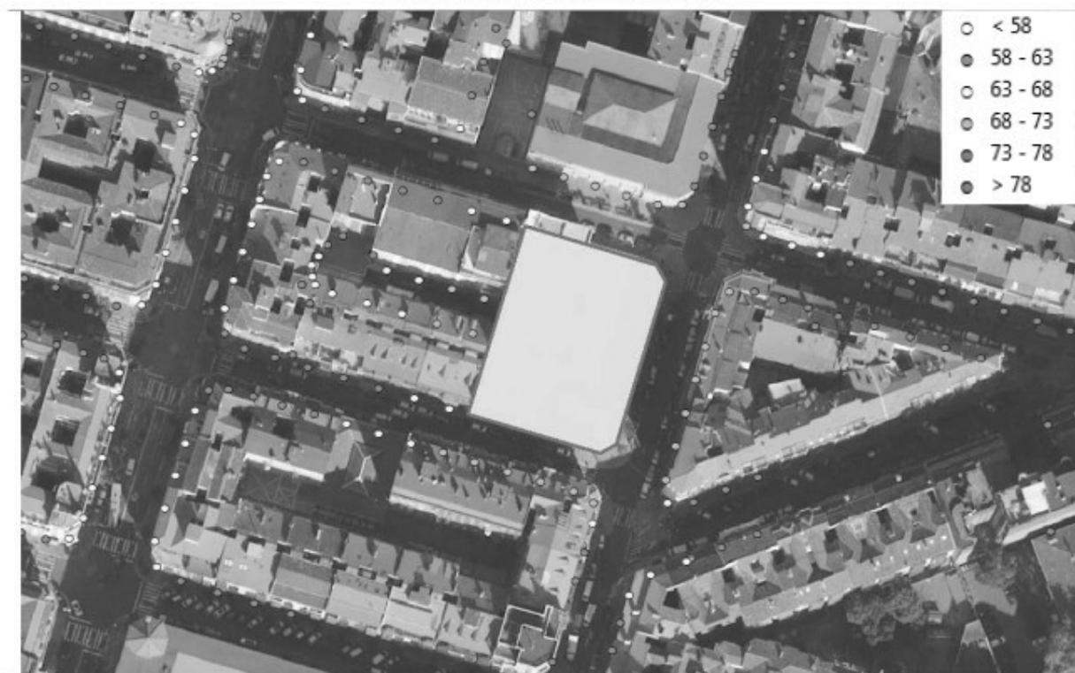
Figura 7. Comparativa de los niveles sonoros incidentes en las fachadas del entorno de la obra en la fase 1.
