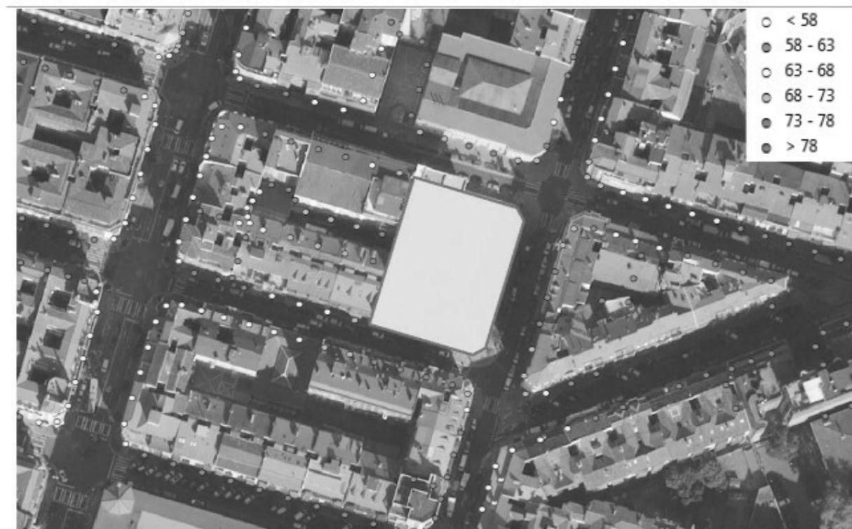
Figura 9. Comparativa de los niveles sonoros incidentes en las fachadas del entorno de la obra en la fase 2.
