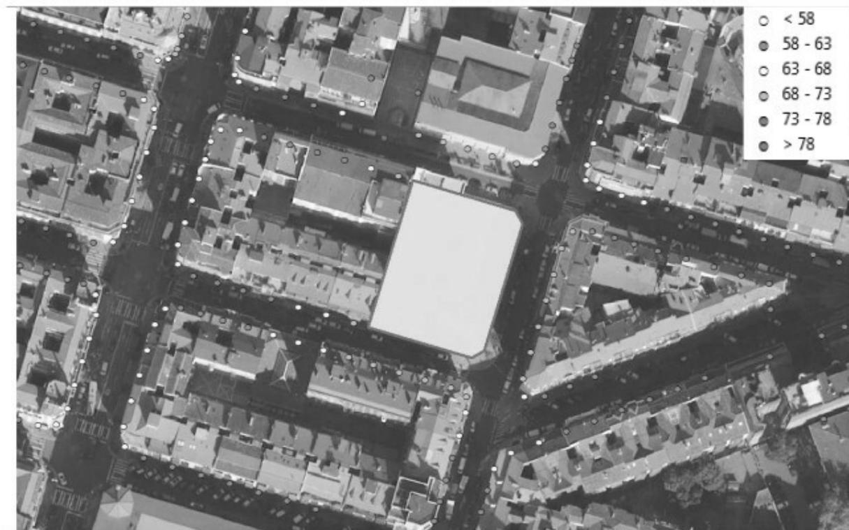
Figura 11. Comparativa de los niveles sonoros incidentes en las fachadas del entorno de la obra en la fase 3.
